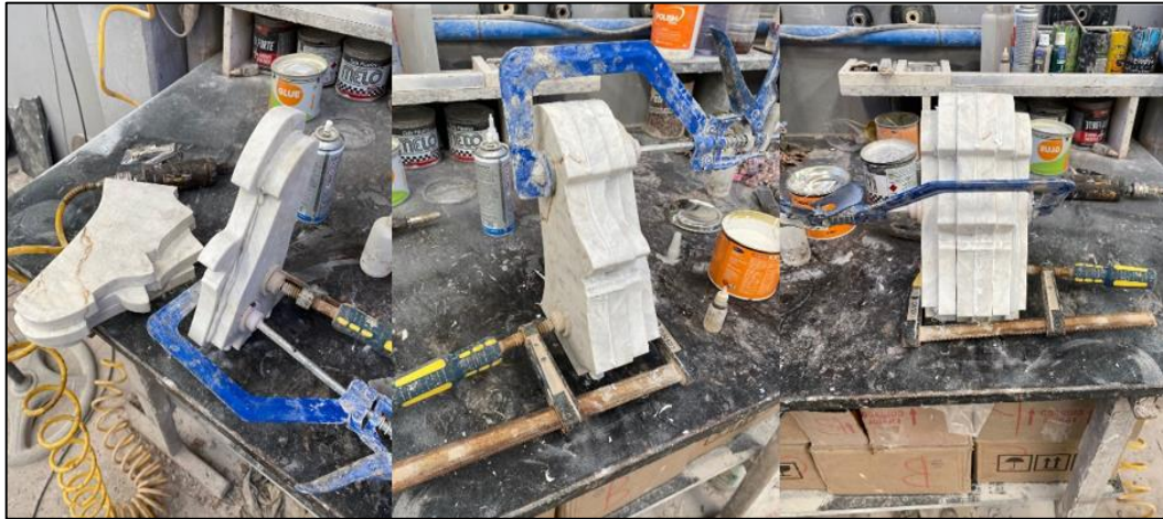
Figura 20 – Colagem do bloco para usinagem manual
