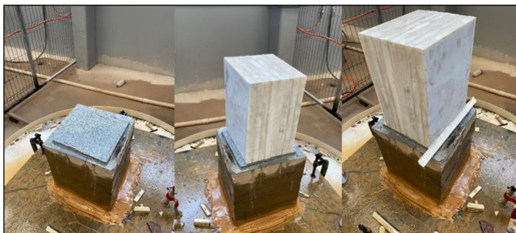
Figura 31 – Fixação do bloco na mesa giratória
