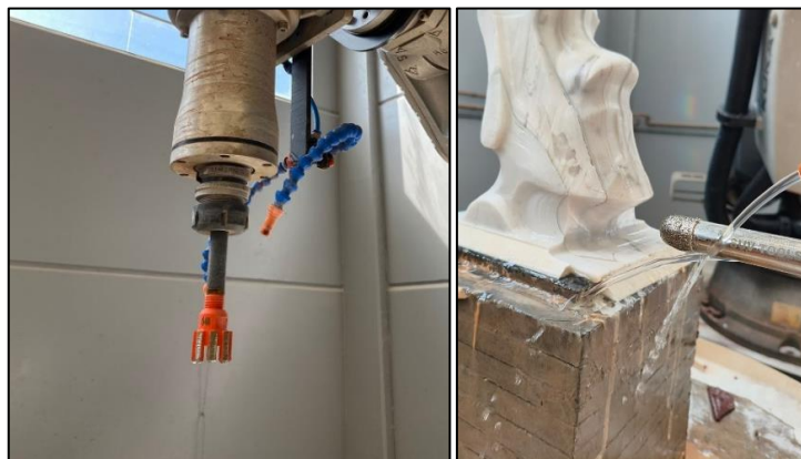
Figura 26 – Comparação entre fresas, D40X28X8 e D21X28X1D
