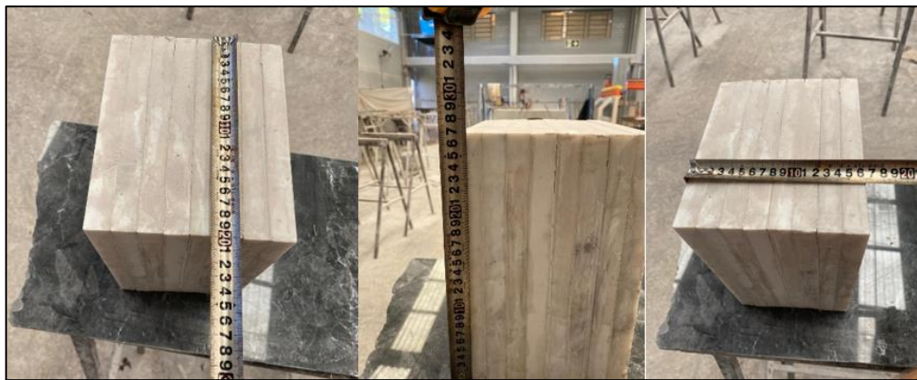
Figura 30 – Colagem do bloco para usinagem robótica
