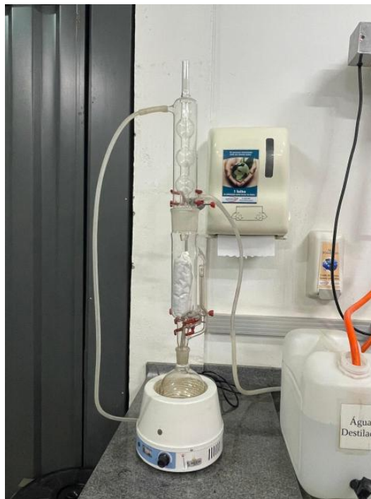
Figura 4 - Aparelho de Soxhlet montado
