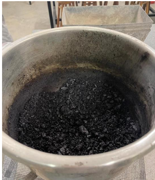
Figura 7 - Mistura asfáltica pronta para ser compactada
