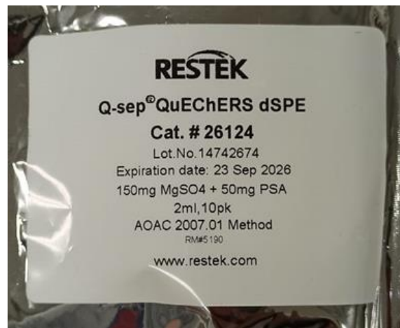
Figura 14: Especificações dos sais de clean-up
