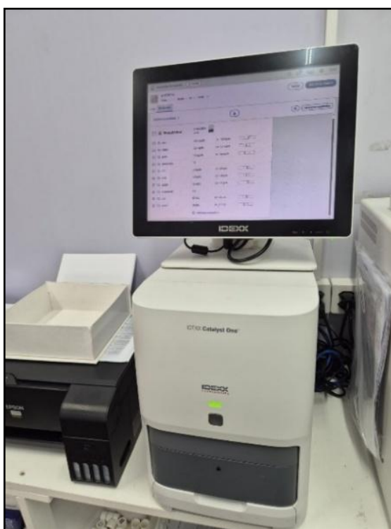
Figura 3 - IDEXX® Catalyst One, analisador bioquímico automático de bioquímica seca
