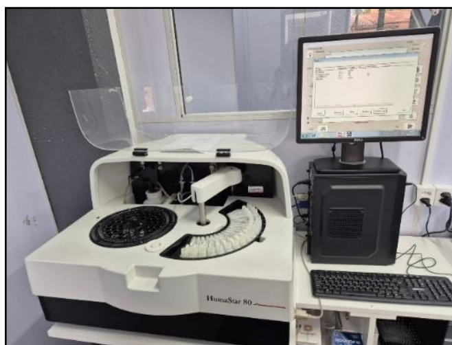
Figura 5 – Analisador bioquímico automático HumaStar® 80 de bioquímica úmida conectado a um computador, utilizado na rotina diária do laboratório
