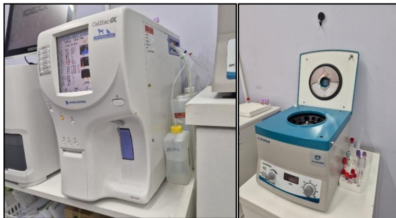
Figura 4 – A) Nihon MEK-6550, contador hematológico. B) Centrífuga CE800, utilizada para centrifugar amostras de tubos de todos os tamanhos e microcapilares
