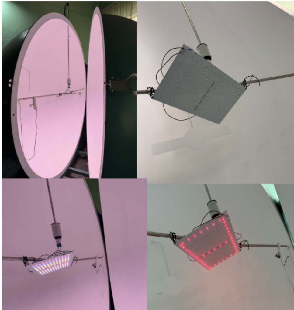
Figura 31 – Ensaio na esfera integradora
