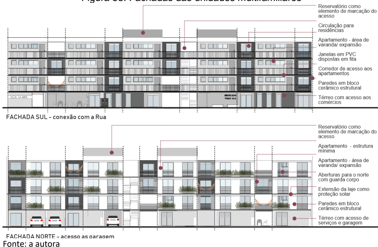
Figura 58: Fachadas das unidades multifamiliares
