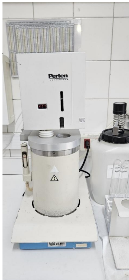
Figura 7: Equipamento para análise de Falling Number , marca Perten.
