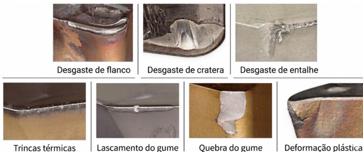
Figura 12 - Desgastes da ferramenta de corte
