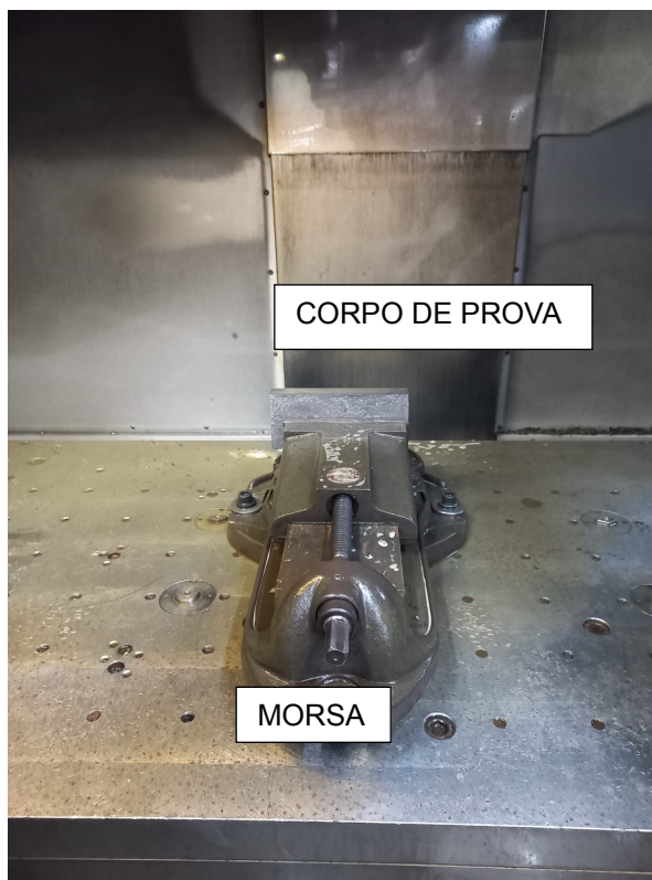
Figura 19 – Adaptação de morsa no centro de usinagem
