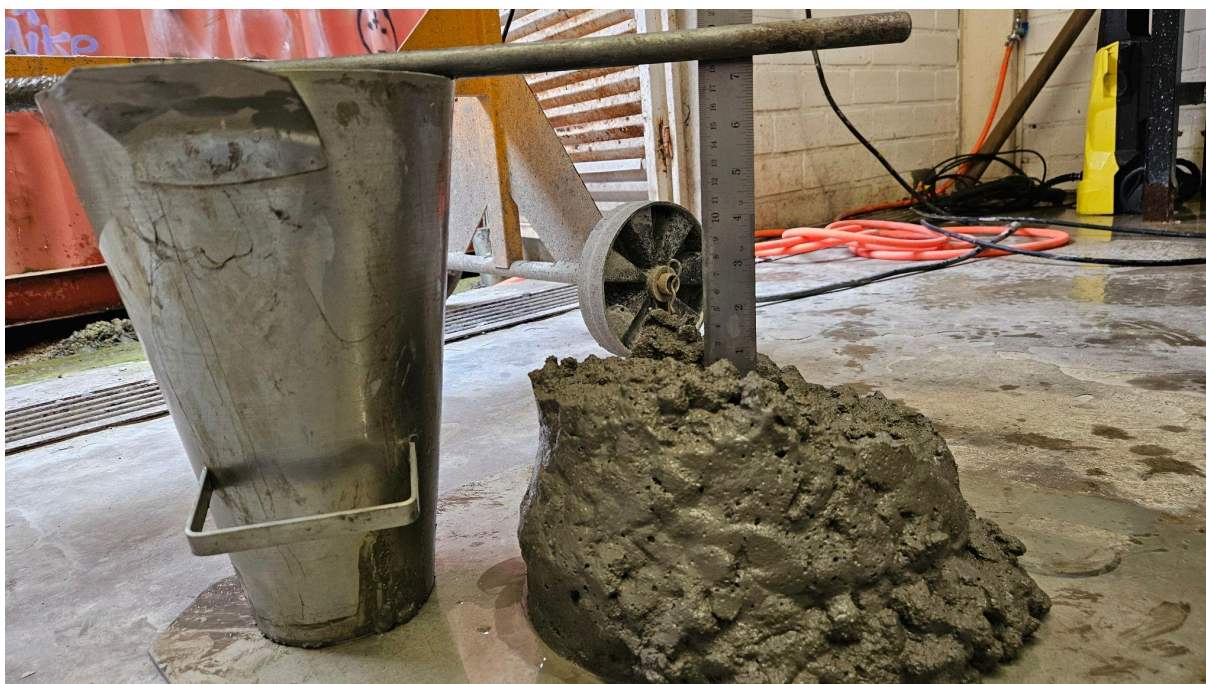
Figura 4 – Aferição do abatimento do concreto.
