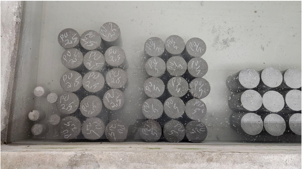
Figura 7 – Corpos de prova no tanque para cura.
