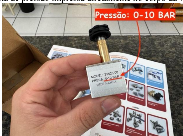
Figura 16 - Faixa de pressão impressa diretamente no corpo da válvula solenoide
