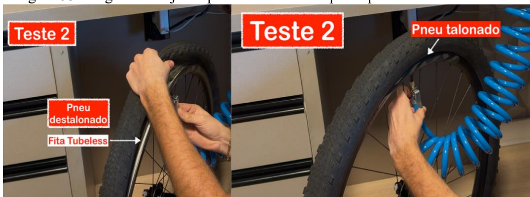
Figura 53 - Segundo conjunto pneu-roda antes e após o processo de talonamento
