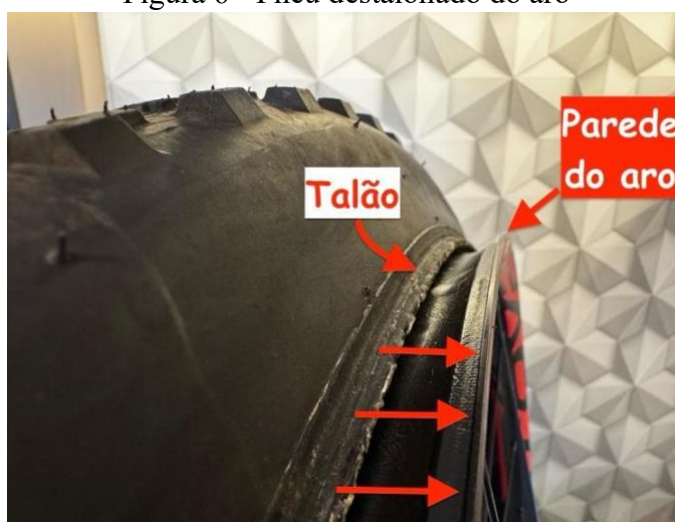
Figura 6 - Pneu destalonado do aro
