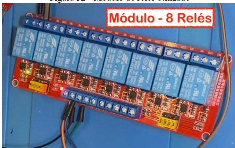
Figura 32 - Módulo de relés utilizado
