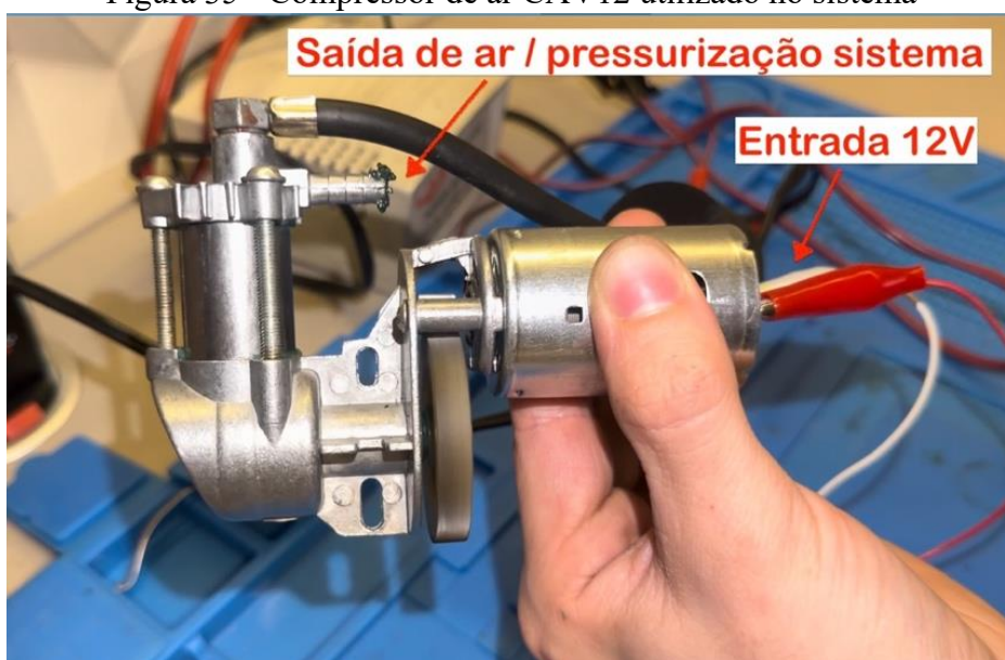
Figura 35 - Compressor de ar CAV12 utilizado no sistema
