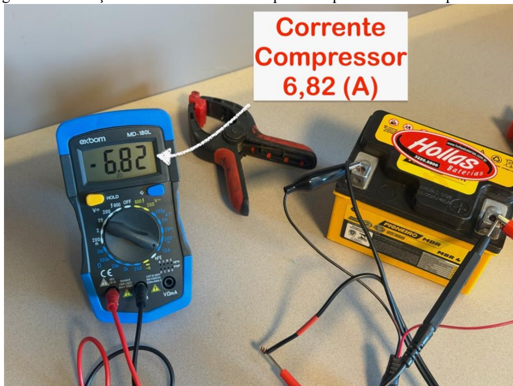
Figura 45 - Medição da corrente consumida pelo compressor durante a pressurização
