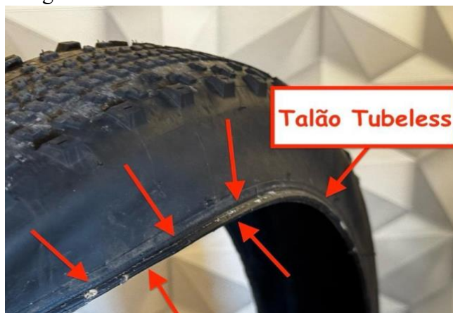
Figura 5 - Pneu tubeless e detalhe do seu talão
