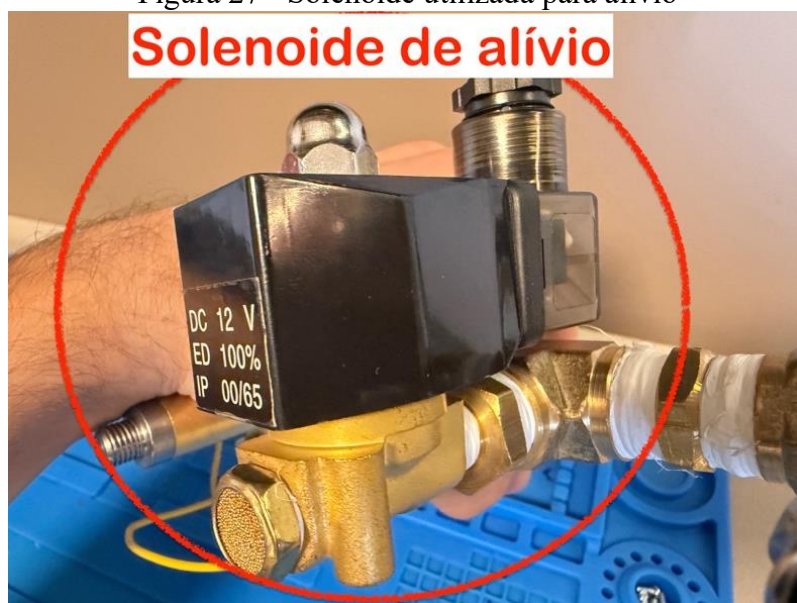
Figura 27 - Solenoide utilizada para alívio
