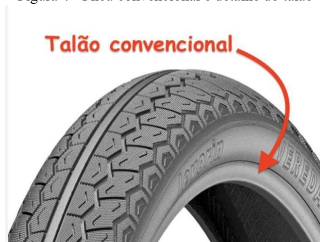
Figura 4 - Pneu convencional e detalhe do talão
