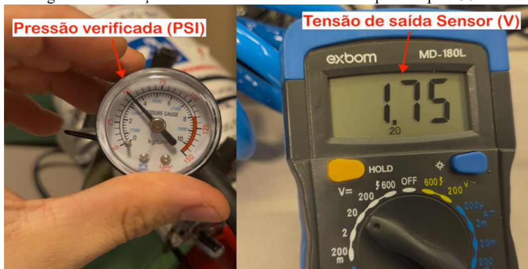
Figura 42 - Medição da tensão de saída do sensor de pressão para 50 PSI
