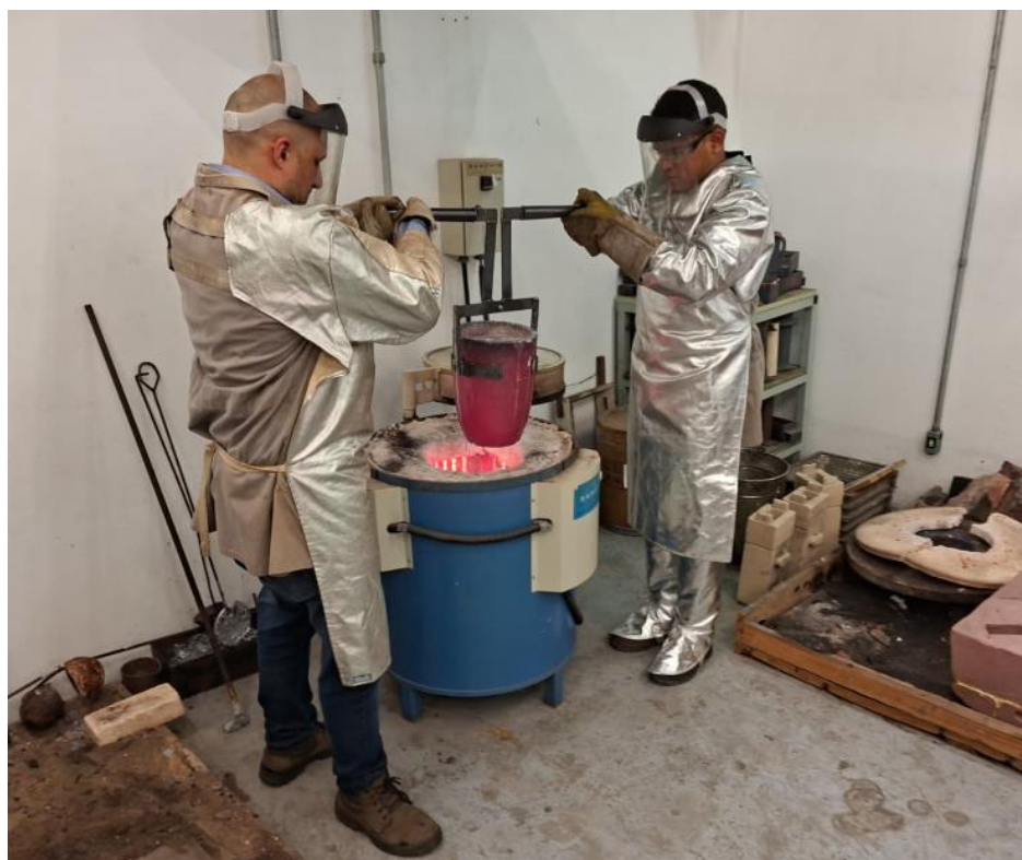
Retirada do cadinho do forno
