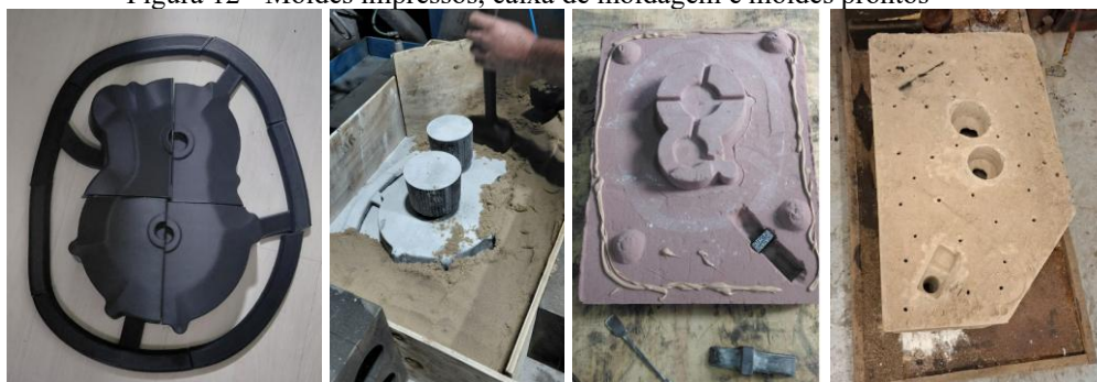
Figura 12 - Moldes impressos, caixa de moldagem e moldes prontos
