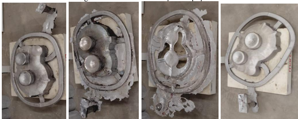
Figura 13 - Arvore de fundição das peças
