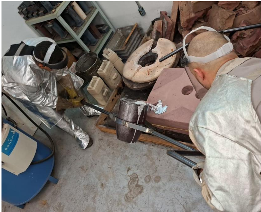
Vazamento do metal no molde de areia
