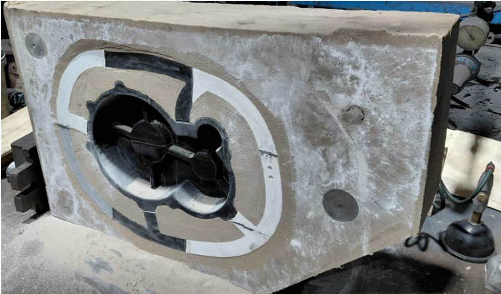
Molde superior curado e ventosa de aplicação do Co 2
