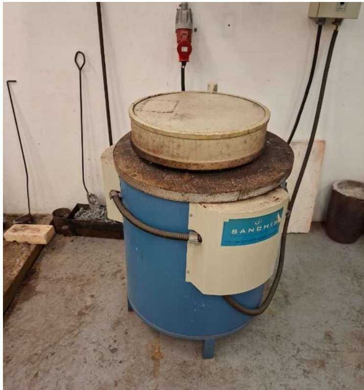
Forno elétrico utilizado para fusão do metal
