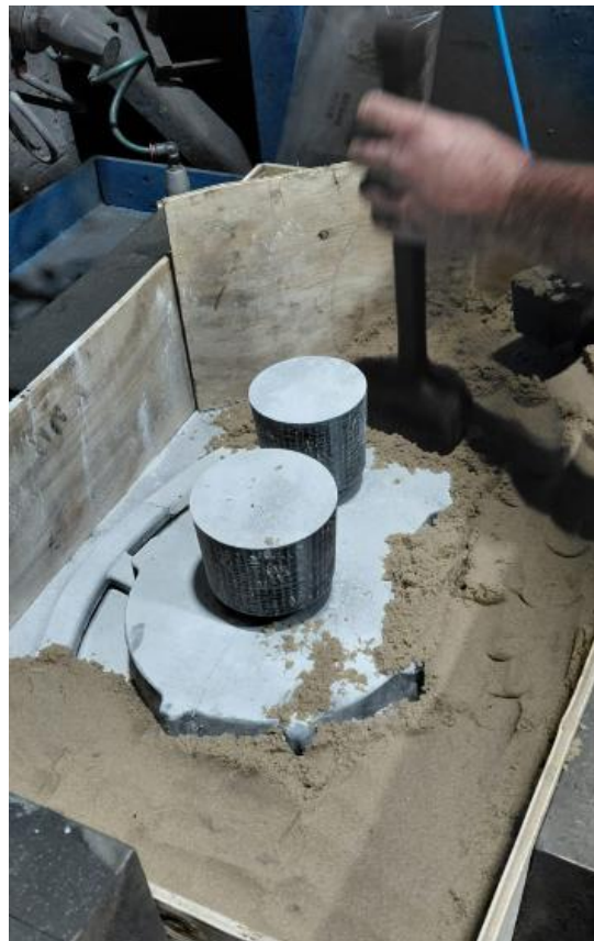
Colocação da areia na caixa
