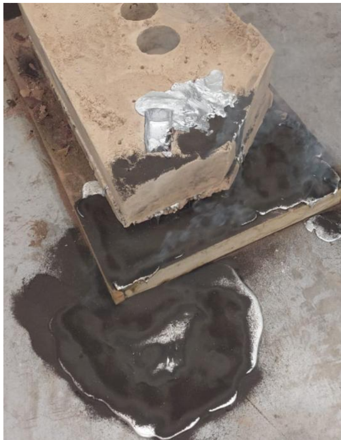
Molde 3 – vazamento linha de separação do molde
