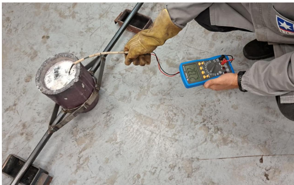
Medição da temperatura do metal
