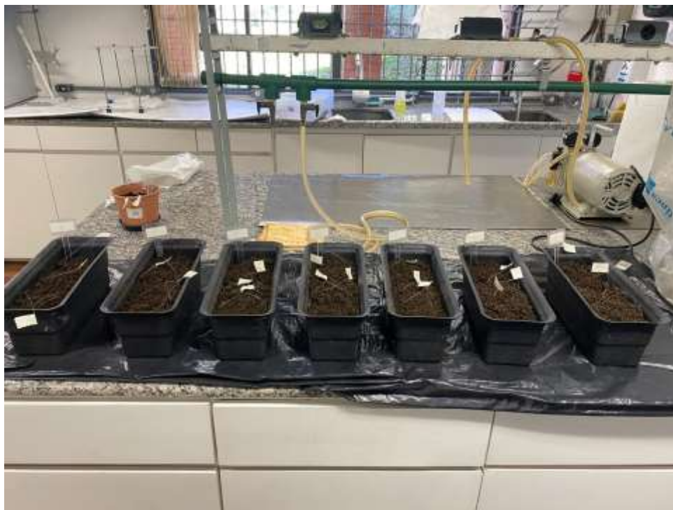
Figura 11. Sistema de análise de biodegradabilidade com amostras dos filmes enterradas em solo (autora, 2025).
