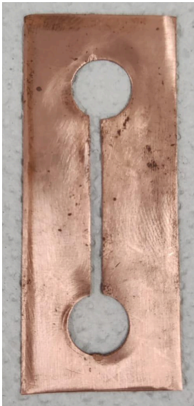
Figura 14 – Máscara de cobre confeccionada e utilizada durante as deposições dos filmes finos.
