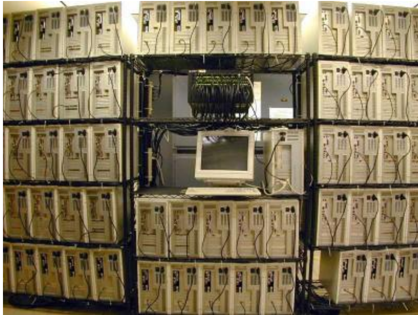
Figura 17 – Cluster com arquitetura Beowulf
