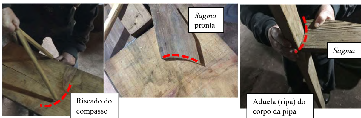
Figura 53 – Construção da sagma para as aduelas
