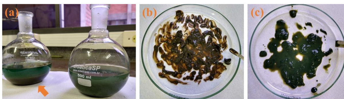
Figura 15 - Partículas formadas (a) antes do processo de centrifugação; e partículas obtidas a partir dos precursores (b) \text{Cu}(\text{CH}_3\text{COO})_2 \cdot \text{H}_2\text{O} e (c) \text{Cu}(\text{NO}_3)_2 \cdot 3\text{H}_2\text{O} , após o processo de centrifugação
