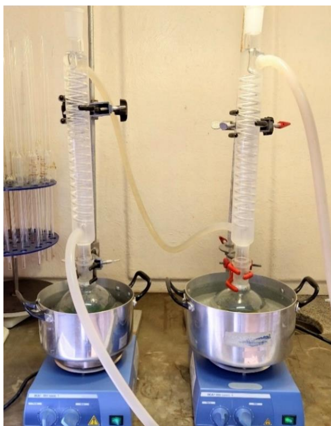
Figura 14 - Sistema com refluxo utilizado na síntese das CuONPs
