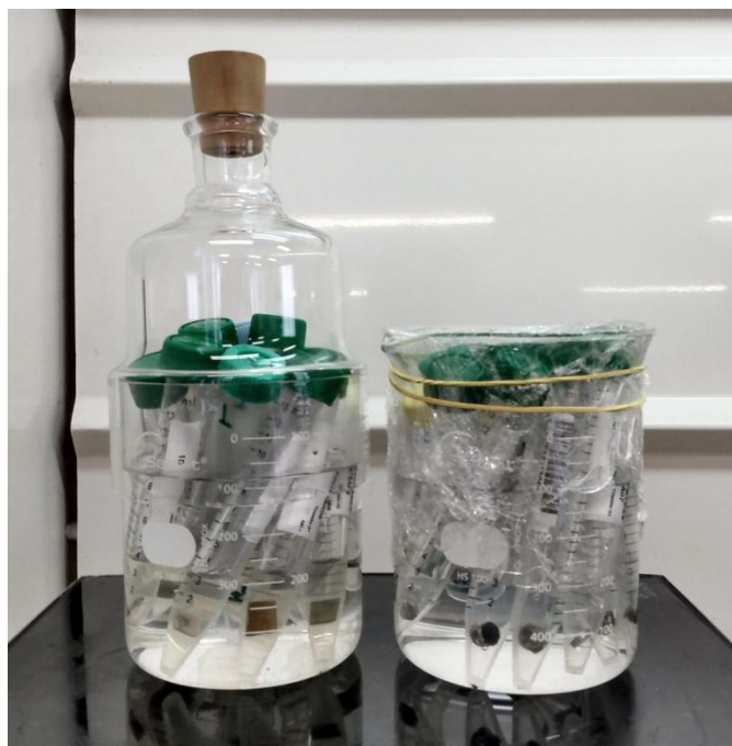
Figura 6: Imagem do teste qualitativo de corrosão.
