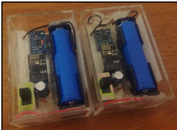
Figura 27: Unidade de aquisição com sensor MPU-9250 e MPU-6050.
