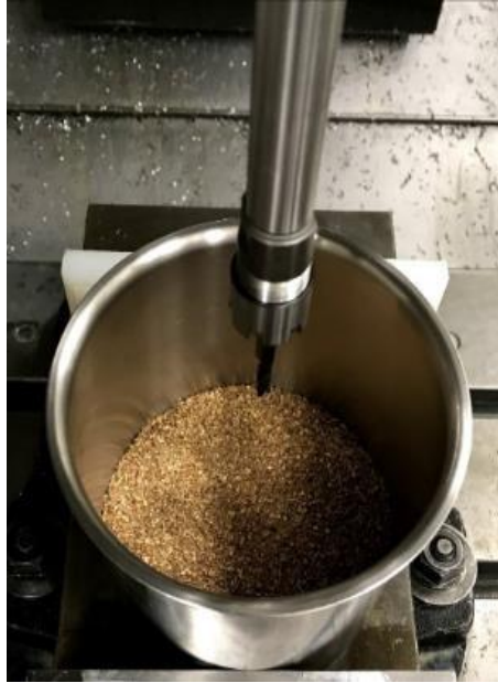
Figura 23 – Polimento da ferramenta por arraste
