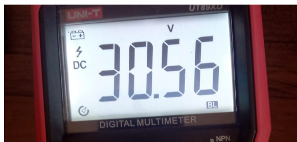
Figura 47 – Tensão medida no capacitor C_1
