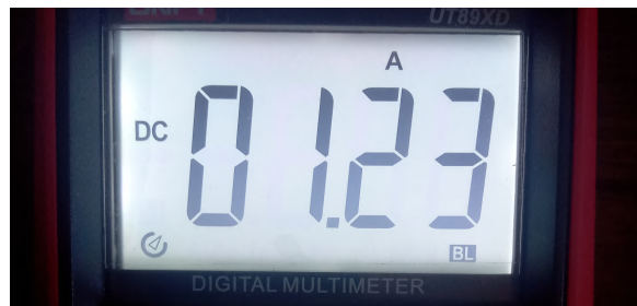
Figura 43 – Corrente medida na entrada do conversor
