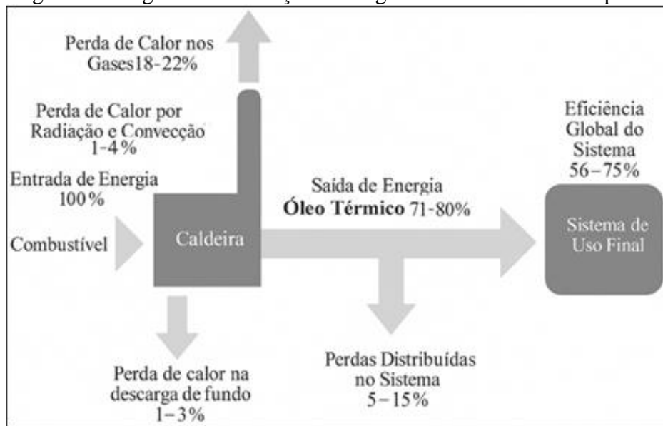
Figura 1 - Diagrama de balanço de energia de uma caldeira com perdas
