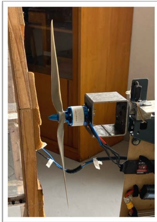
Figura 13 – Conjunto motor-hélice para ensaio em túnel de vento
