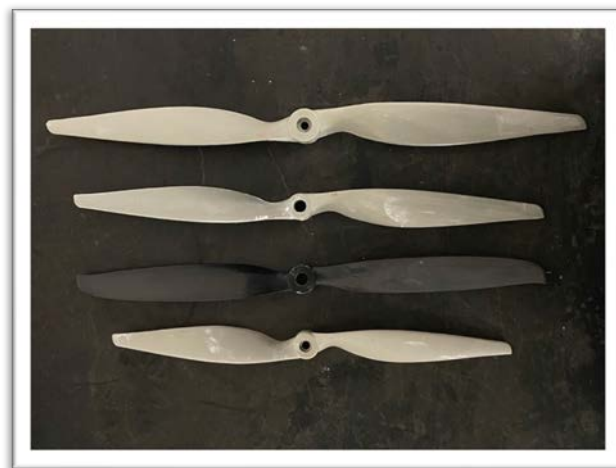
Figura 12 – Hélices comerciais selecionadas para o estudo (em ordem, 16x8, 14x7, 14x7 Sport e 12x6)
