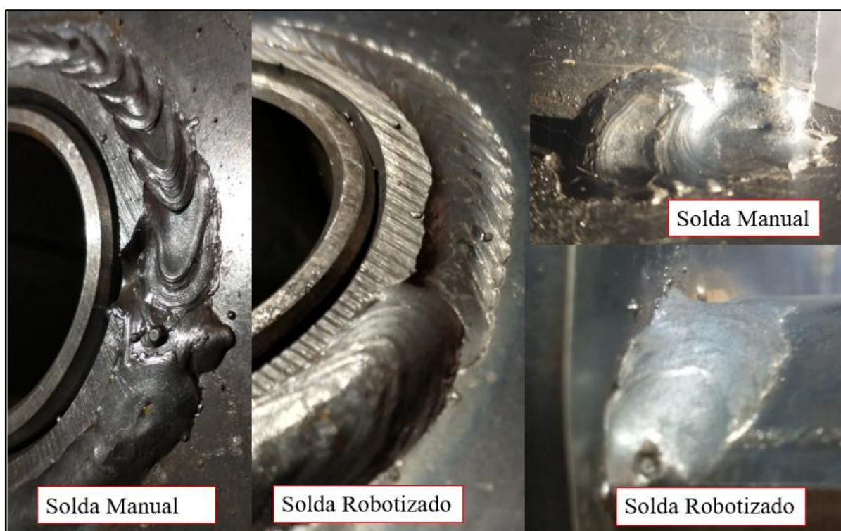
Figura 27 – Aspecto visual dos cordões de solda analisados.
