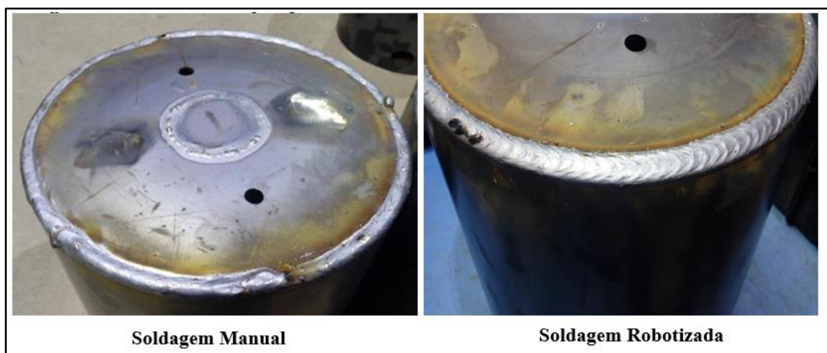
Figura 7 – Análise Visual do Cordão de Solda: Análise Comparativa entre Soldagem Manual e Robotizada.
