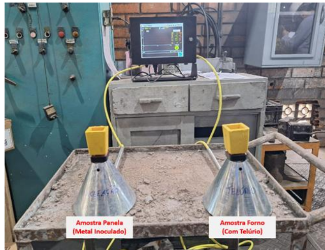
Figura 17 - Equipamento de análise térmica montado ao lado do forno
