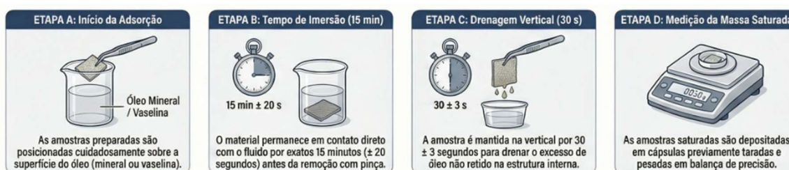
Figura 18 – Representação das etapas do ensaio de adsorção das amostras em óleo mineral lubrificante/vaselina
