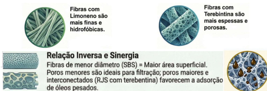
Figura 43 – Correlação das características superficiais das fibras de EPS produzidas pelos processos de fiação SBS e RJS, a partir de soluções de R-(+)-limoneno e terebintina
