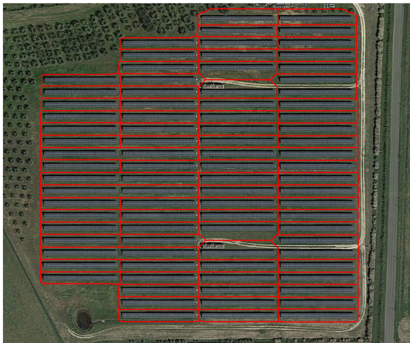
Figura 26 – Esqueleto extraído após a poda, sobreposto à imagem da usina.
