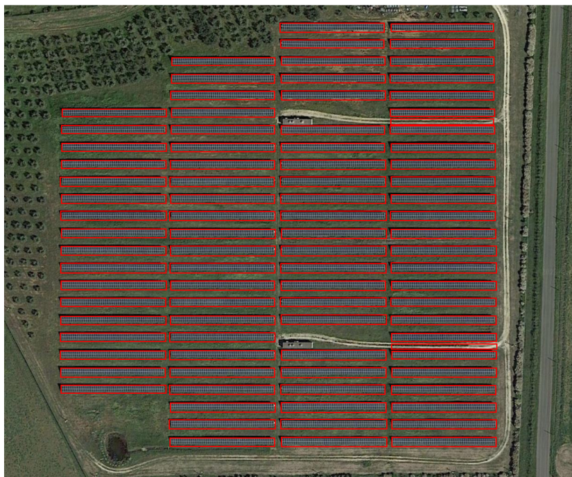
Figura 24 – Resultado da detecção das fileiras de módulos fotovoltaicos pelo YOLOv8m, com as bounding boxes sobrepostas à imagem aérea da usina.
