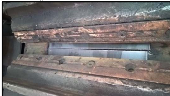
Figura 32 - Defeito no corte da tira
