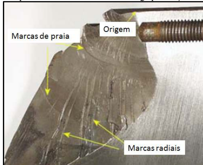
Figura 11 - Marcas de praia e radiais na fratura de fadiga por torção de um eixo SAE 4340
