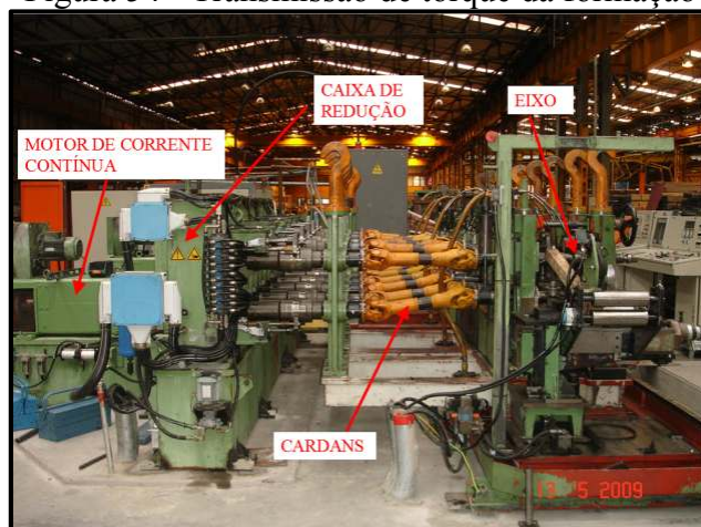
Figura 54 - Transmissão de torque da formação
