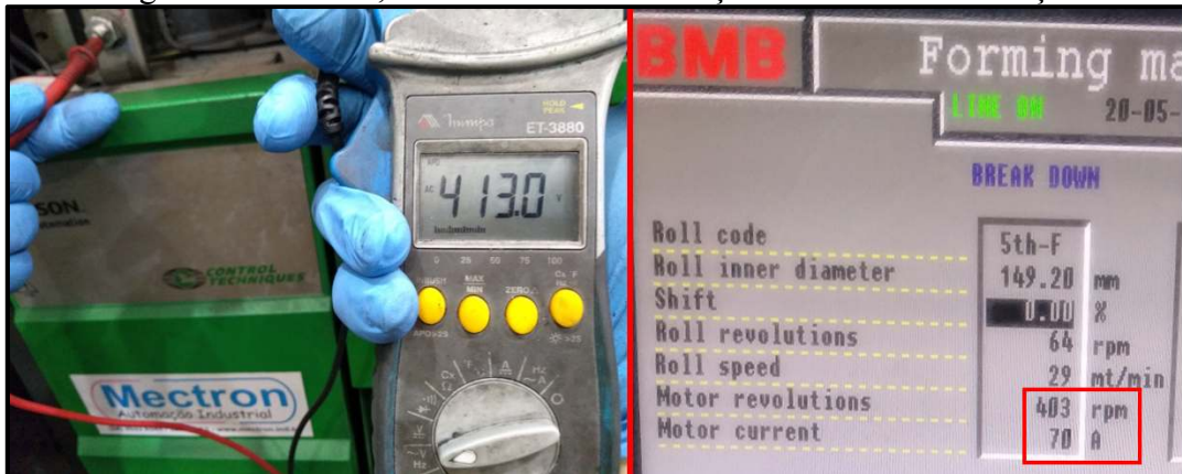
Figura 55 - Tensão, corrente elétrica e rotação do motor da formação
