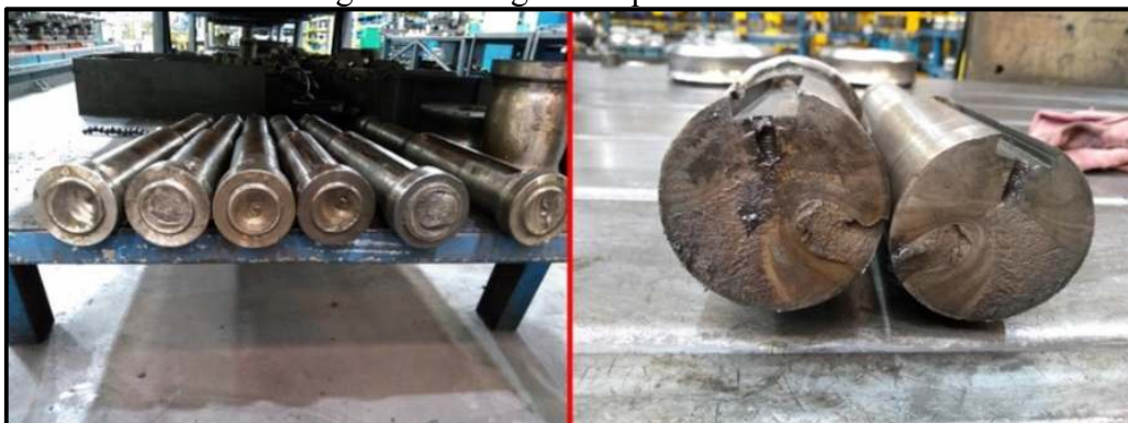
Figura 13 - Região da quebra do eixo
