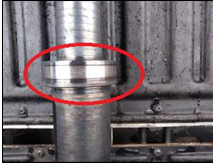
Figura 35 - Eixo sem têmpera na região de diâmetro maior
