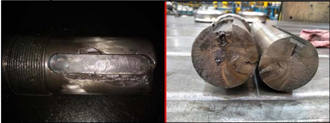
Figura 22 - Quebra dos eixos com problemas no tratamento térmico
