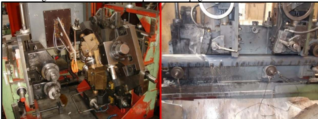
Figura 46 - Solda de alta frequência e raspagem do cordão de solda
