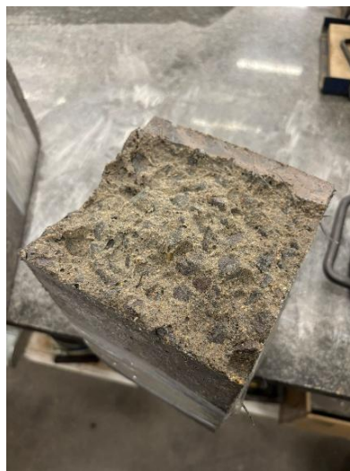
Figura 32 – Arrancamento das fibras CR P0,4/C0,4
