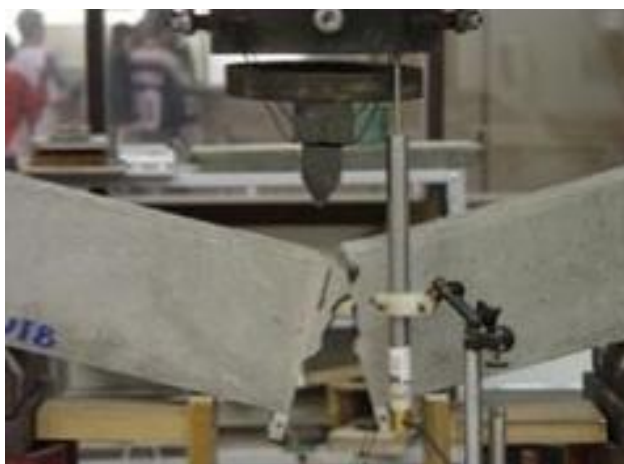
Figura 3 – Rompimento traço sem fibras
