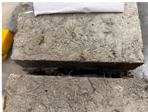
Figura 30 – Rompimento parcial CR A0,6/C0,2
