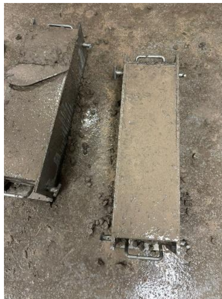
Figura 24 - Exsudação CR P0,6/C0,2 Figura 25 - Exsudação CR P0,4/C0,4
