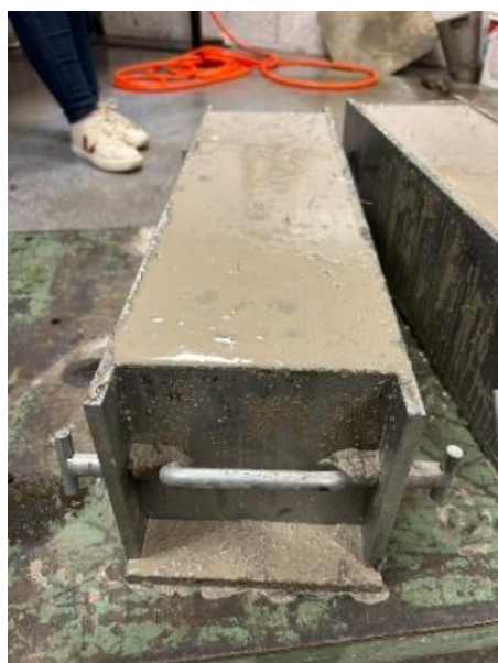
Figura 24 - Exsudação CR P0,6/C0,2 Figura 25 - Exsudação CR P0,4/C0,4
