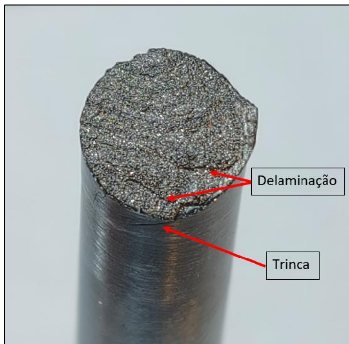
Figura 30 – Superfície de fratura do corpo de prova submetido ao ensaio de tração
