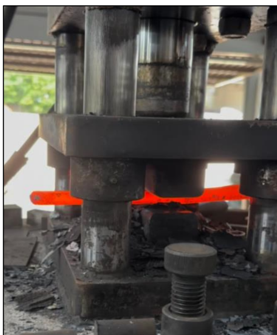
Figura 23 – Forjamento da barra
