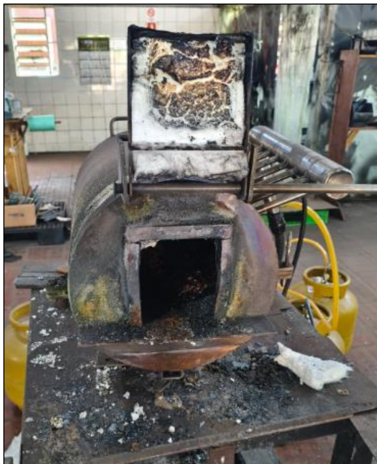
Figura 19 – Fornalha a gás para caldeamento de aço damasco
