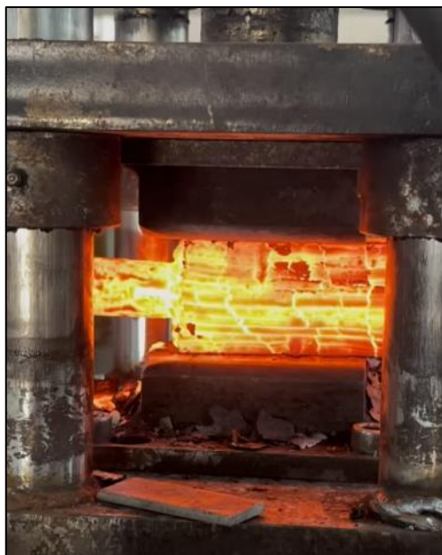
Figura 22 – Billet em processo de caldeamento
