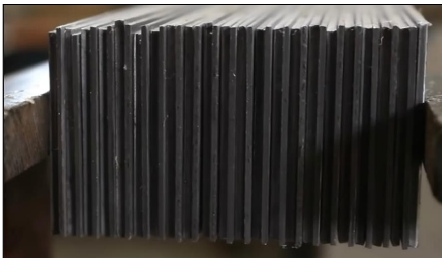
Figura 17 – Lâminas de aço SAE 1084 e UHB 15N20 intercaladas para formar o billet
