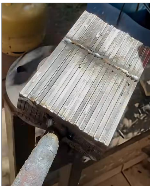
Figura 18 – Billet soldado pronto para o caldeamento
