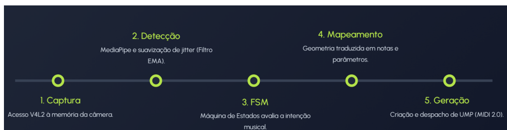
Figura 9 – Diagrama de Arquitetura do Aerochord: Módulos de processamento e comunicação assíncrona
