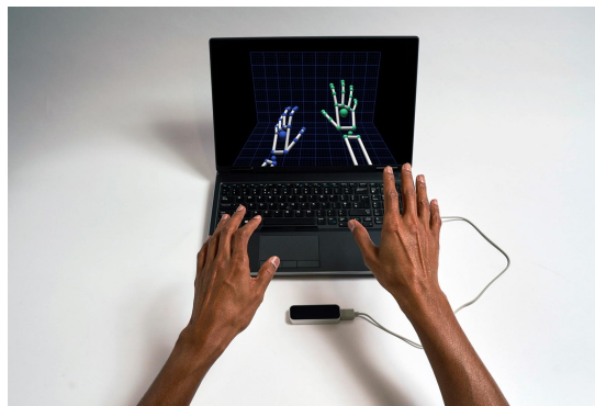
Figura 2 – Controlador Leap Motion em uso para rastreamento de movimentos das mãos
