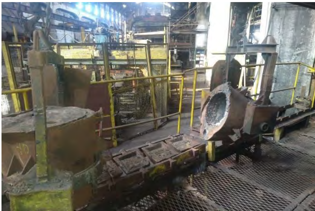
Figura 39 – Vista do cadinho pequeno em uma linha do processo de moldagem.
