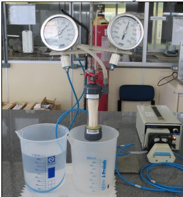
Figura 19 – Módulo de membranas submetido à retrolavagem durante a limpeza química.
