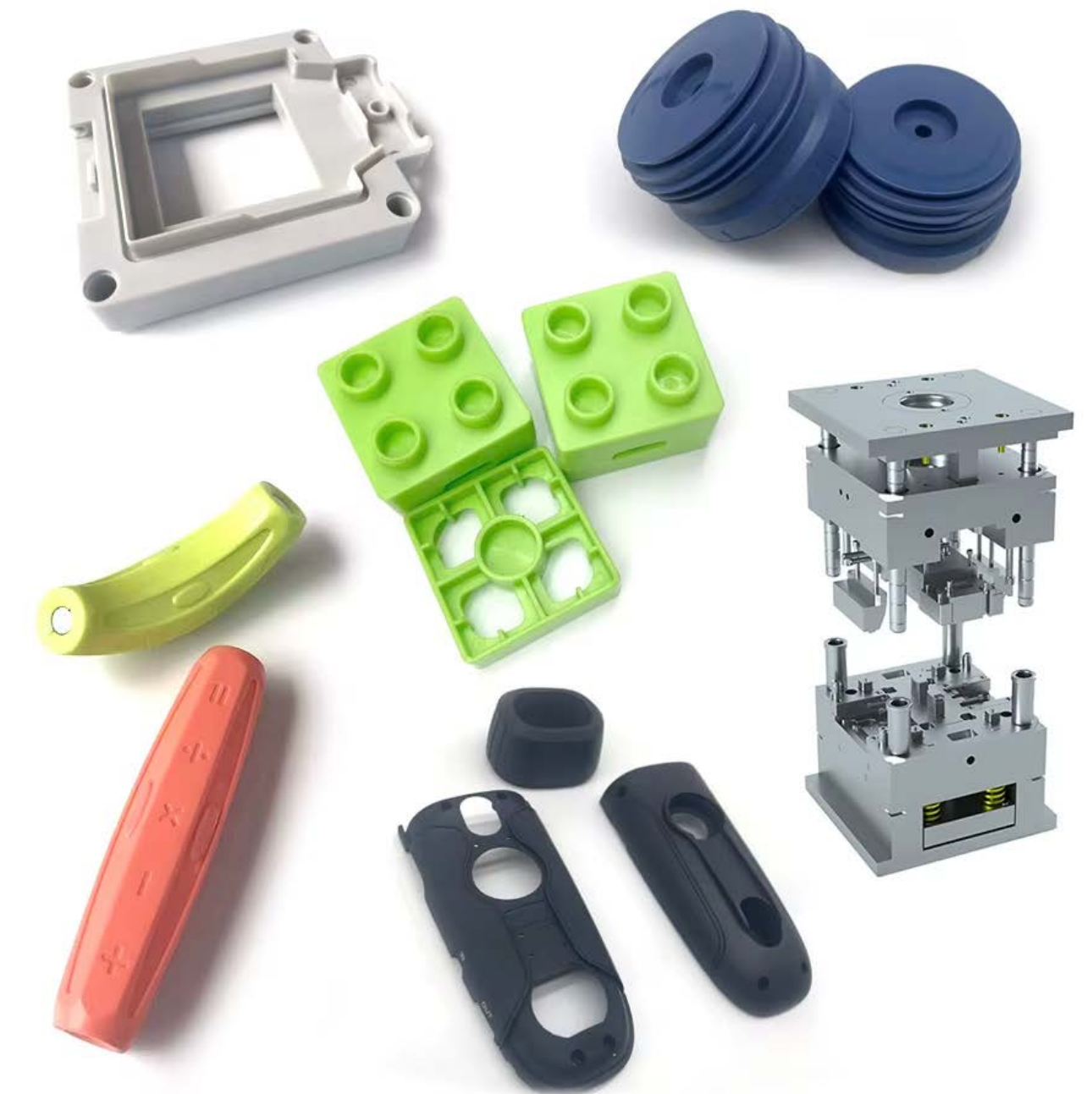
Exemplo de peças em ABS e molde para fabricação por meio de injeção de plástico.
