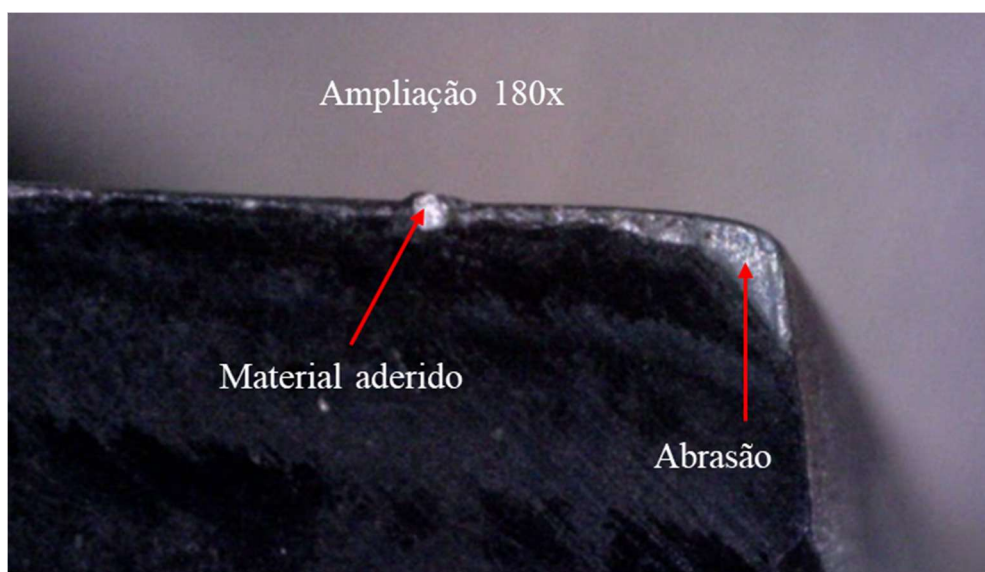
Figura 45 – Ampliação da quina, condição reafiada com escovamento
