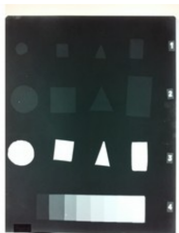
Figura 7: Posicionamento do Objeto-Modelo de Densidade Radiográfica, em (A) grupo de formas geométricas, em 1 formas de Alumínio, 2 Ferro, 3 Chumbo e 4 penetrômetro e em (B) radiografia do Objeto-Modelo de Densidade Radiográfica.
