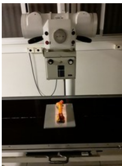
Figura 4: Experimento com chassi radiográfico, tela intensificadora (ecran) para a simulação de exposição a um fêmur suíno.
