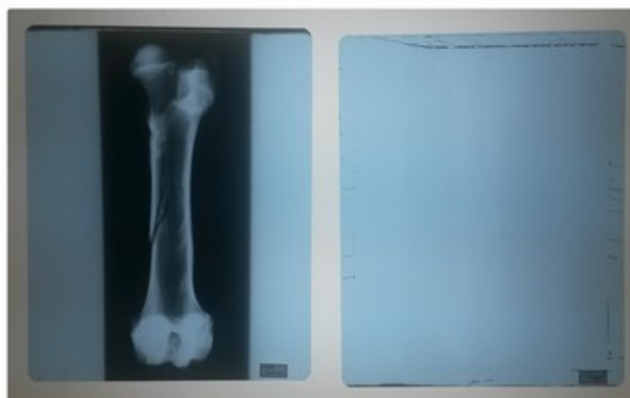
Figura 6: Resultados obtidos no experimento “Simulação de Exposição Radiográfica em um Sistema tela-filme”. Na esquerda, imagem obtida com o uso de um chassi radiográfico com tela intensificadora e na direita, imagem obtida com chassi desprovido de tela intensificadora.
