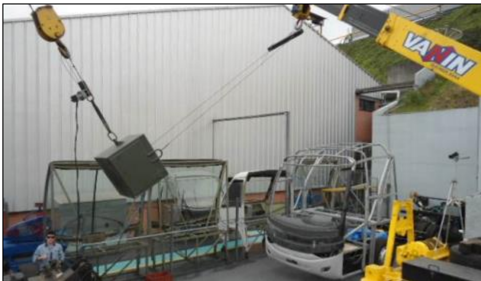
Figura 6 - Teste do pêndulo
