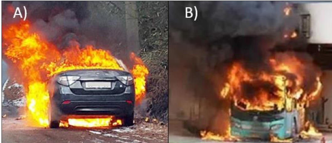
Figura 2 - Veículos com baterias de lítio em chamas
