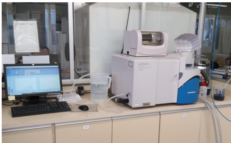
Figura 17. Analisador de partícula Horiba LA – 950 V2 . Fonte: O autor, 2022.
