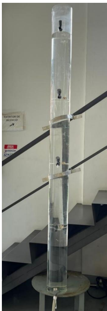
Figura 16. Torre de sedimentação de sólidos. Fonte: O autor, 2022.
