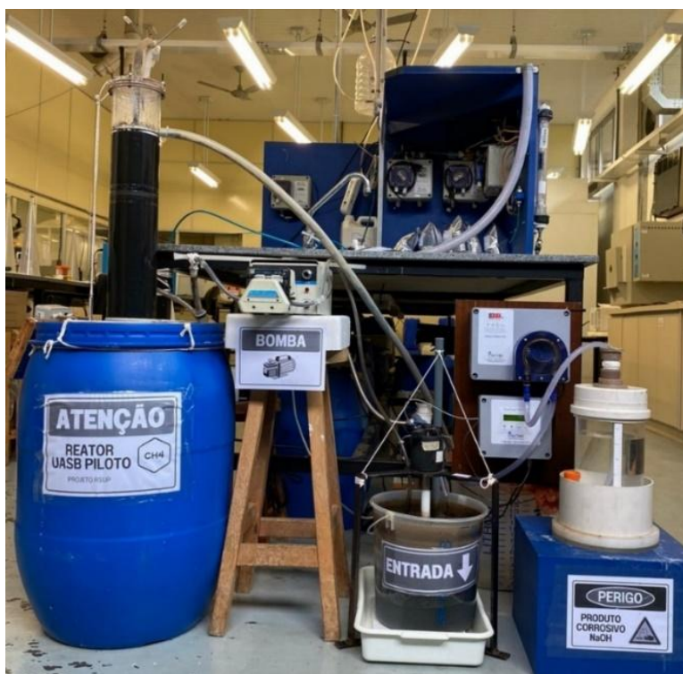
Figura 18. Reator UASB piloto para o teste de fluxo contínuo. Fonte: O autor, 2022.
