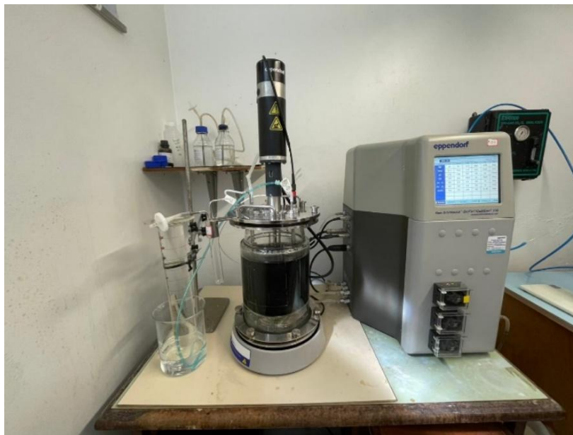
Figura 8. Teste da AME em reator anaeróbio de bancada. Fonte: O Autor, 2022.
