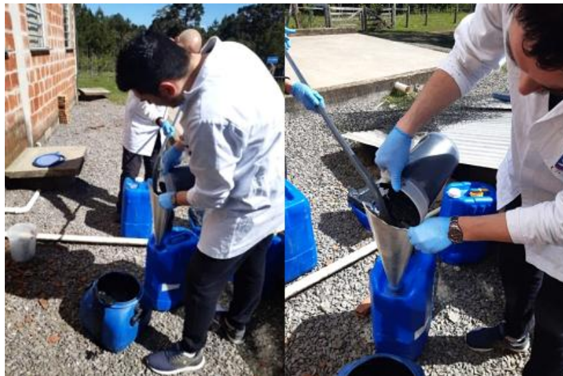
Figura 22. Coleta do lodo do reator UASB na UCS - Fazenda Escola. Fonte: O autor, 2022.
