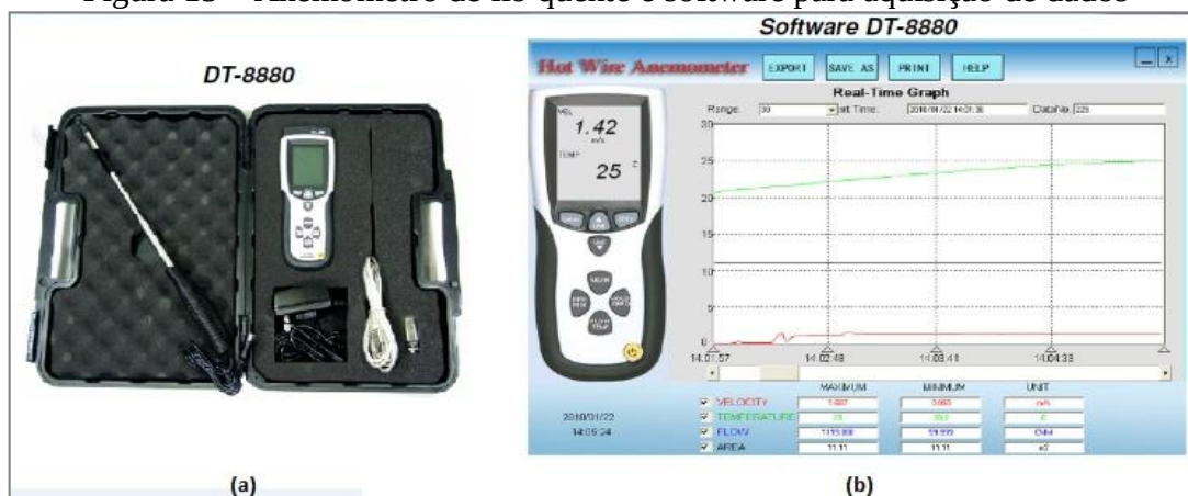
Figura 15 – Anemômetro de fio quente e software para aquisição de dados
