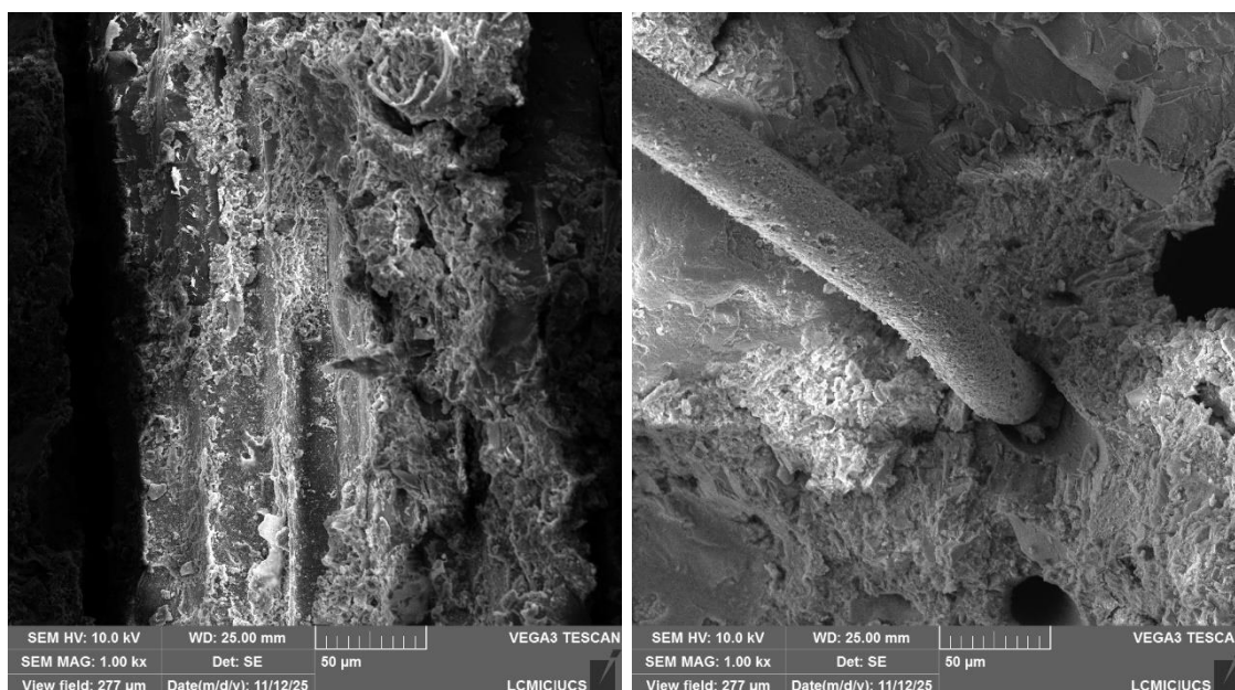
Figura 30 - Análise do MEV traços 1M e 1 PP (1000x)
