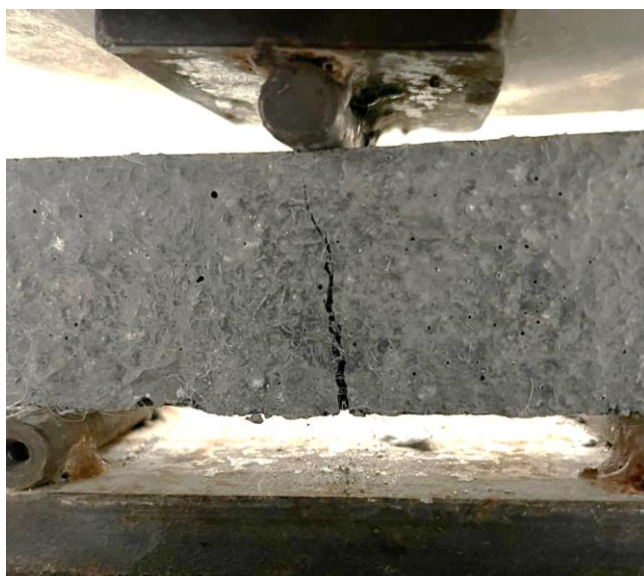
Figura 25 - Efeito do ponteamto de fissuras.
