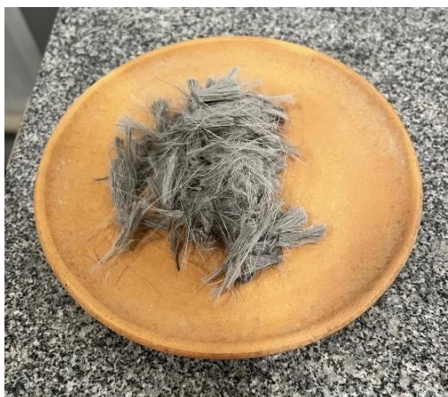
Figura 11 - Fibra sintética de polipropileno
