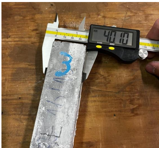
Figura 16 - Ensaio de densidade no estado endurecido
