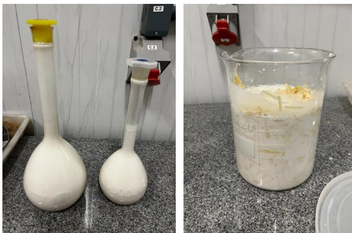
Figura 8 - Tratamento das fibras de palha de milho com \text{Ca(OH)}_2 .
