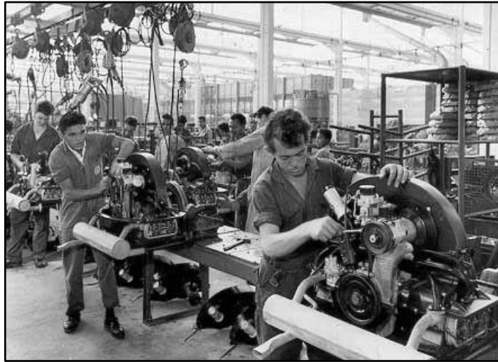
Figura 3: Linha de montagem do Volkswagen Fusca
