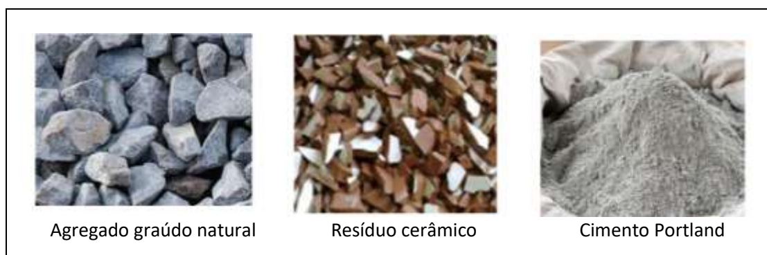
Figura 6 - Materiais utilizados na execução dos corpos de prova de concreto
