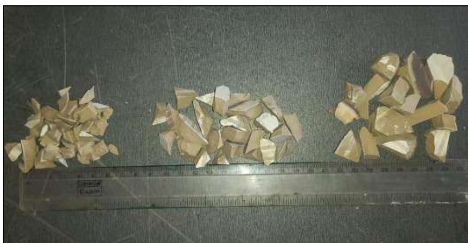
Figura 4 - Resíduo de revestimento cerâmico.
