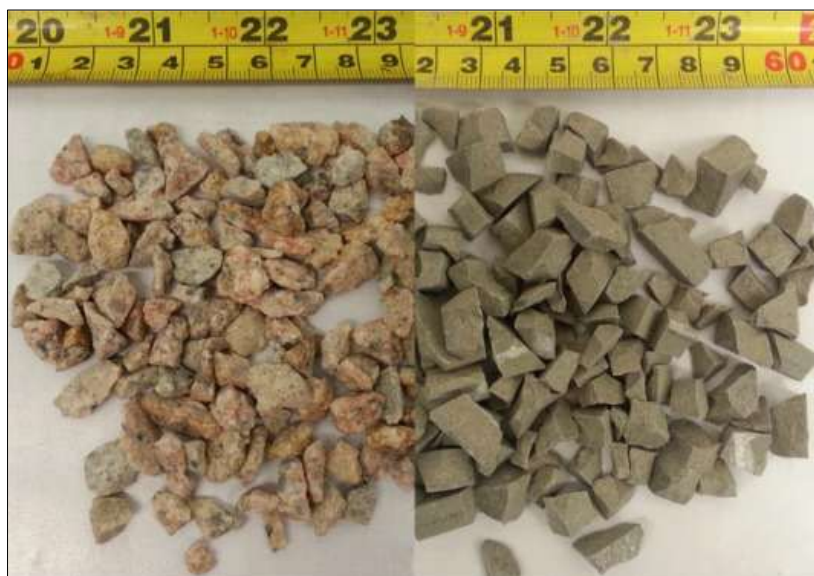
Figura 3 - Agregado graúdo natural e agregado graúdo de revestimentos cerâmicos.
