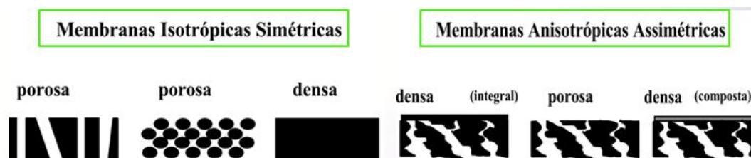
Figura 4. Representação esquemática da seção transversal dos diferentes tipos de morfologia de membranas sintéticas (adaptado de HABERT et al. , 2006).
