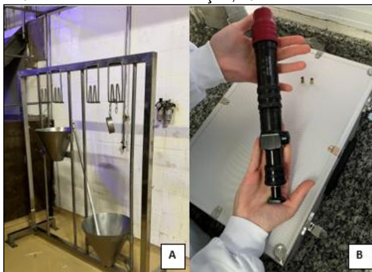
Figura 20 – 20A – Plataforma de contenção; 20B – Pistola de dardo cativo.
