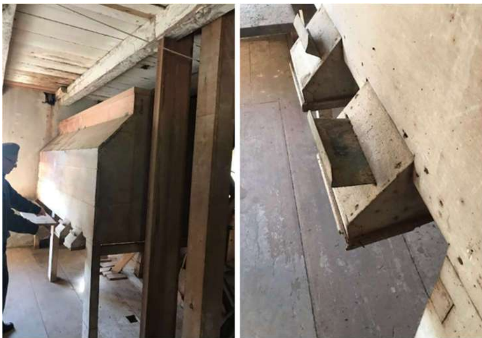
Figura 33 - Depósito de resíduos e Egydio manipulando a chapa metálica que fecha e abre a armazenagem
