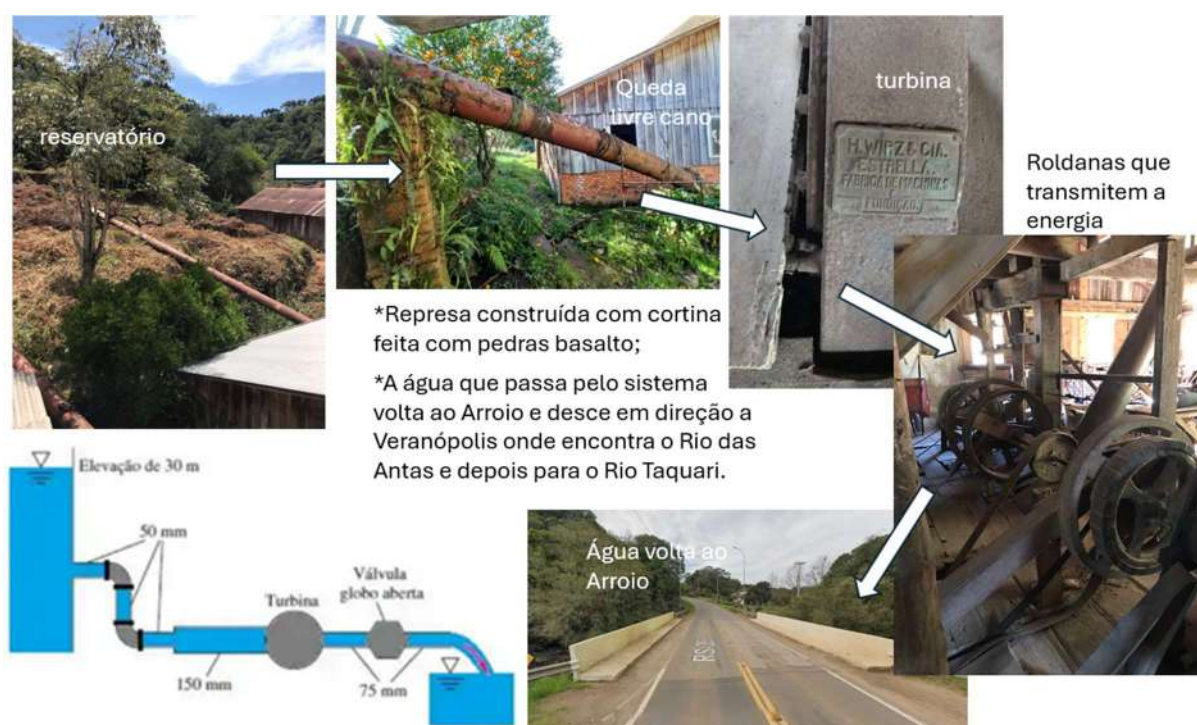
Figura 59 - Sistema em sequência de geração de energia
