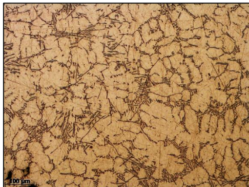
Figura 29 – Microestrutura obtida por MO das ligas Al-7Si com adição da anteliga experimental Al-1,5Nb-0,5B. Ataque com reagente Keller. (a) Amostra 4 (0,1 % Nb). (b) Amostra 5 (0,3 % Nb). Aumento de 100×
