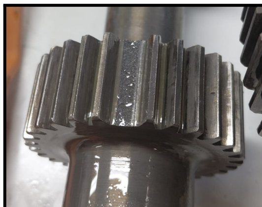
Figura 1 - Fratura por fadiga de flexão em um dente de engrenagem.
