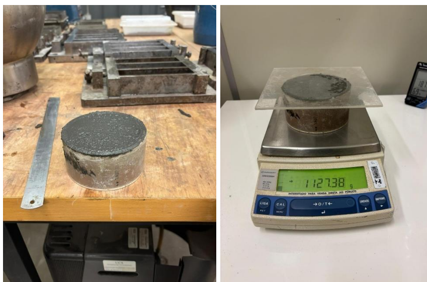
Figura 20 - Ensaio da densidade no estado fresco
