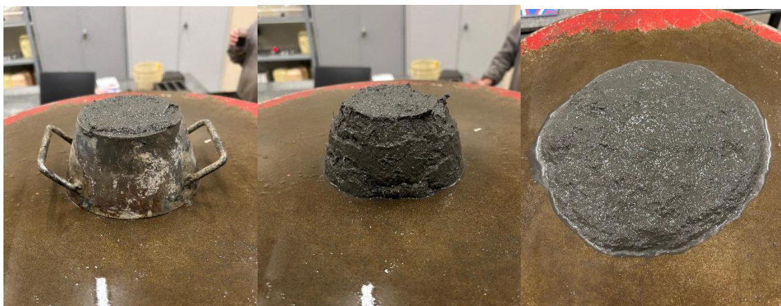
Figura 19 - Ensaio do índice de consistência
