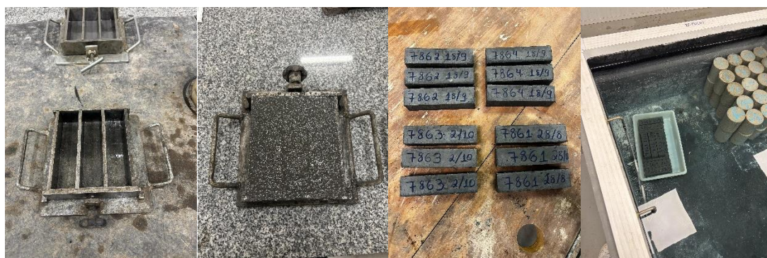
Figura 21 - Processo de moldagem e desmoldagem dos compósitos
