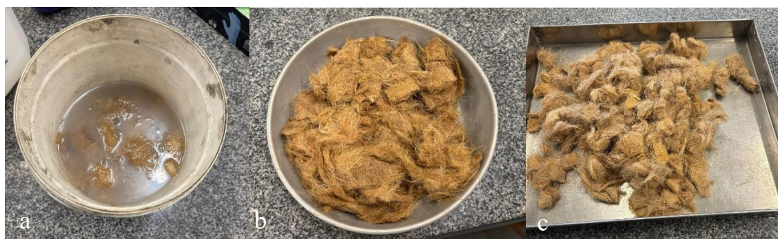
Figura 15 – Tratamento alcalino com hidróxido de cálcio
