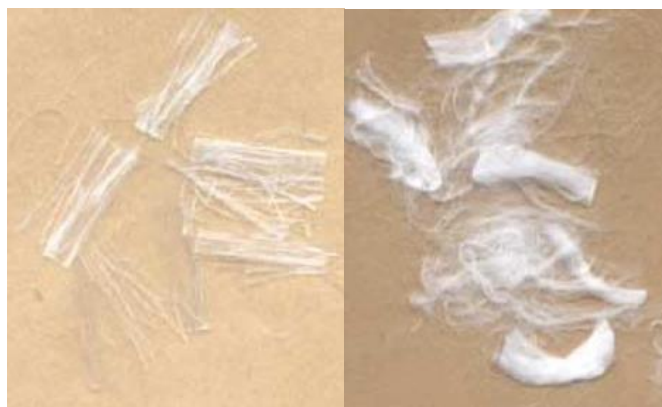
Figura 3 - Fibras de polipropileno do tipo fibrilado (a) e do tipo monofilamento (b)
