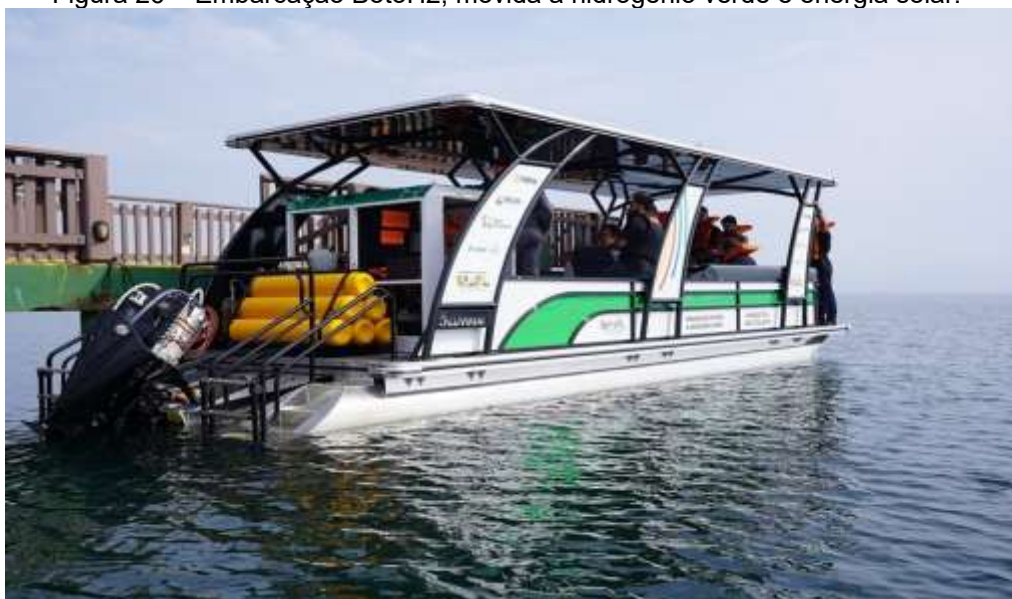
Figura 26 – Embarcação BotoH2, movida a hidrogênio verde e energia solar.
