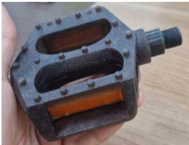
Figura 45 – Pedal de bicicleta elétrica produzido com biocomposto de tucumã e açaí
