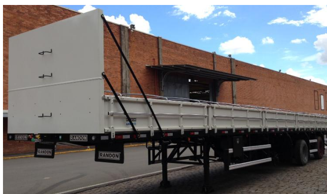
Figura 12 - Semirreboque Carga Seca Bobineiro
