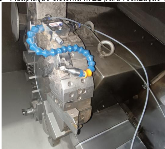
Figura 49 - Adaptação sistema MQL para realização dos testes
