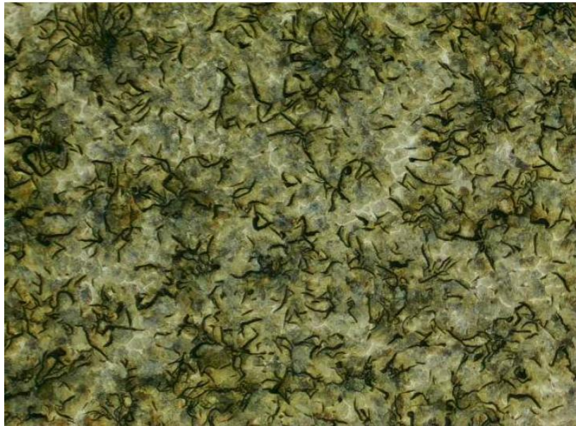
Figura 26 – Análise metalográfica da matriz com ampliação de 100X. Perlítica com rede aberta de Steadita. Carboneto <1%
