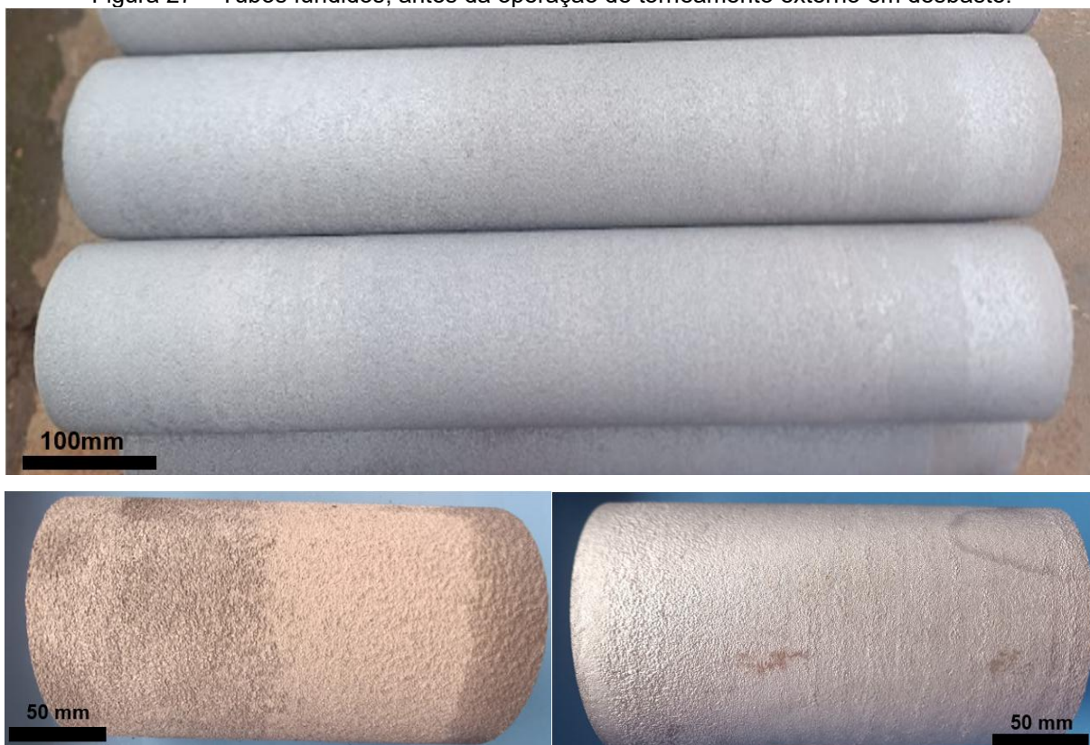
Figura 27 – Tubos fundidos, antes da operação de torneamento externo em desbaste.
